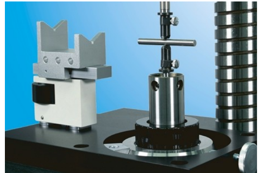
Messung von kurzen Prüfstiften
